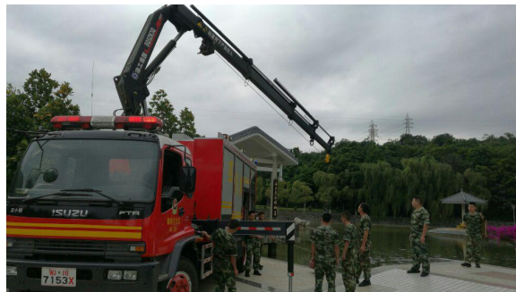
远程消防取水设备
